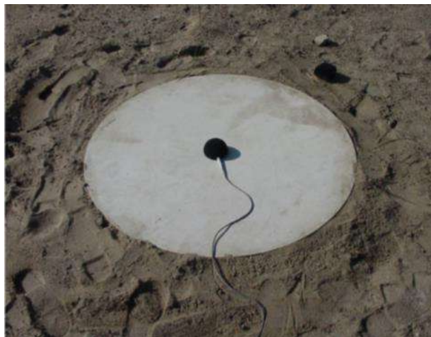
Micrófono y plataforma de medición de ruido acústico requeridos por el estándar IEC 61400-11 de 2012.
